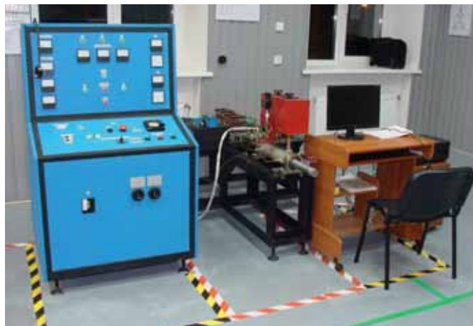
Испытательный стенд типа ЮКЛЯ, дополненный рабочим местом оператора на базе ПК
