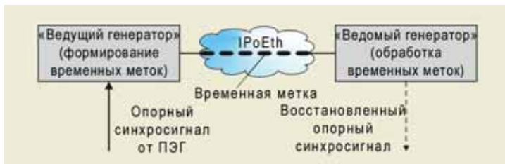
Рис. 3. Общая схема синхронизации с использованием способа ToP: ПЭГ – первичный эталонный задающий генератор; IPoEth – сеть IP, функционирующая поверх Ethernet
