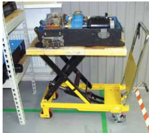
Транспортная тележка с регулируемой высотой грузовой платформы
