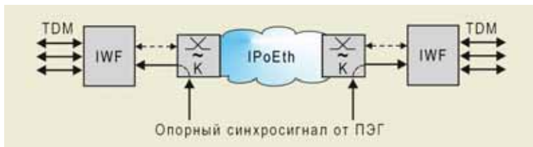
Рис. 2. Общая схема синхронизации с использованием способа SyncE: IPoEth – сеть IP, функционирующая поверх Ethernet; TDM – сеть с временным разделением каналов; IWF – узел межсетевое взаимодействия; K – коммутатор Ethernet, поддерживающий SyncE
