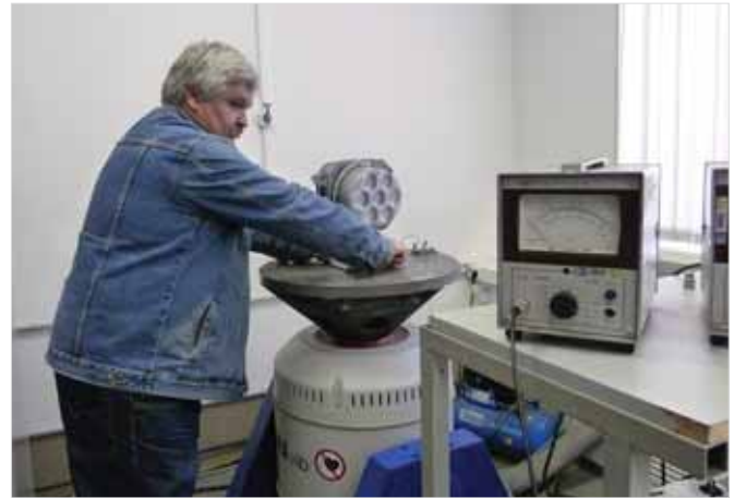
Ведущий инженер Ю.Ю. Савельев работает на вибростенде для проверки реле и малогабаритных устройств
