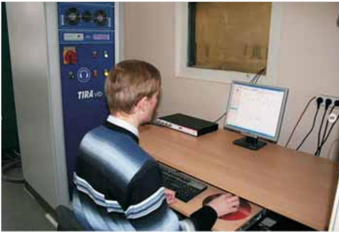
Рабочее место, с которого испытатель управляет вибростендами и разрывной машиной
