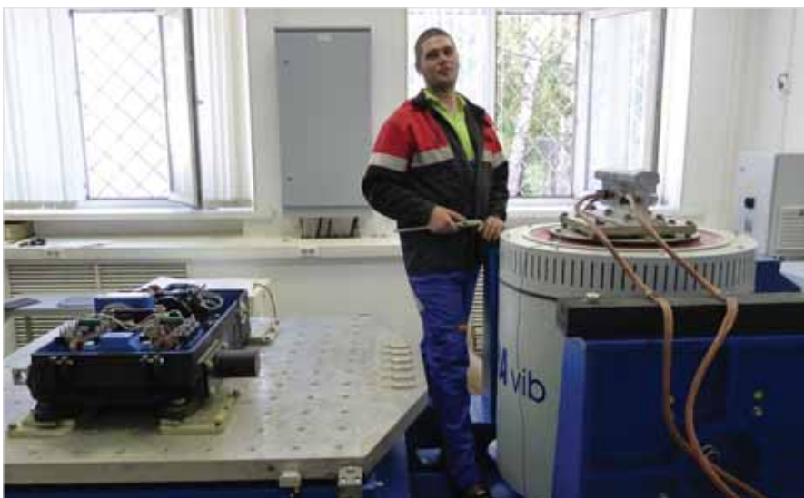
Главный специалист по испытаниям К.А. Запreeв у вибростенда для проверки электроприводов
