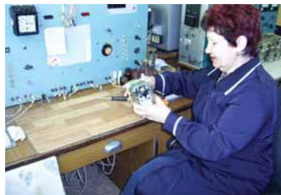
Электромеханик КИПа СЦБ Л.П. Гаврилова проверяет реле
